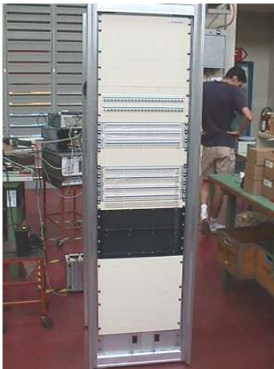
Erdbebensicherer Schrankaufbau mit Kreuzverband: 8MF-Schrank von Siemens
